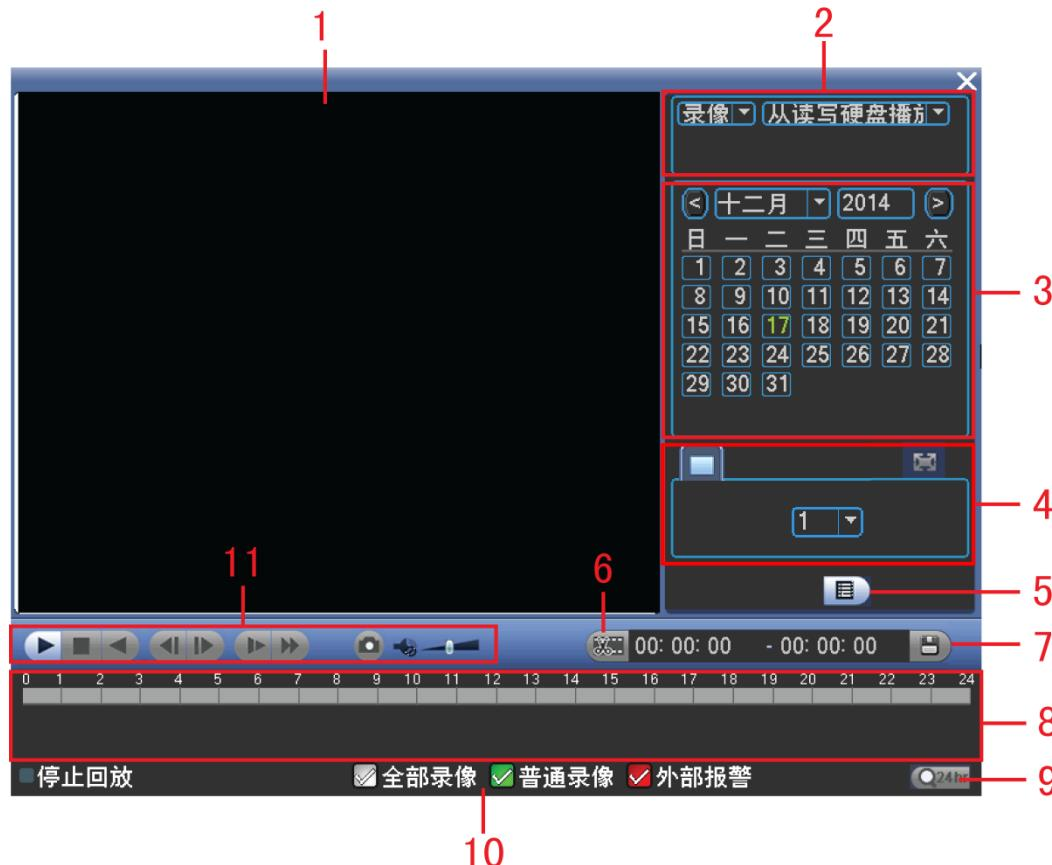
设备本地的录像查询界面和功能与 WEB 端的类似,因此有关本地录像查询界面参数的解释,请参见“4.3.1 回放界面”。
