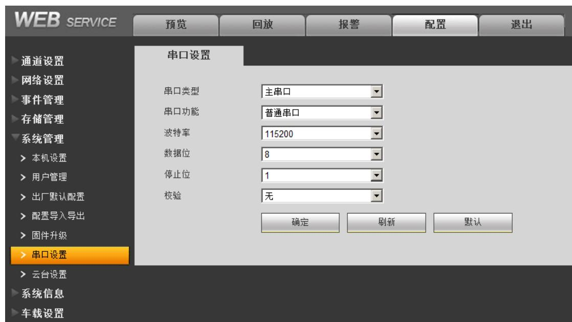
【串口类型】选择串口类型，包括主串口、串口 1 和串口 2。
