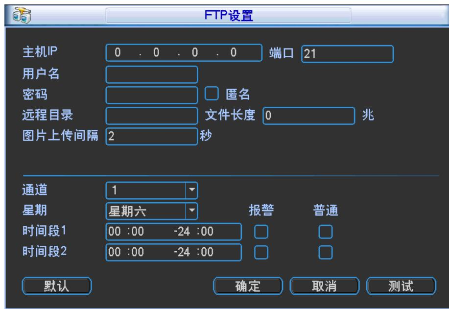
步骤7 设置 FTP 服务器地址、端口、远程目录等。远程目录为空时，系统会自动按 IP、时间、通道建立不同的文件夹。
