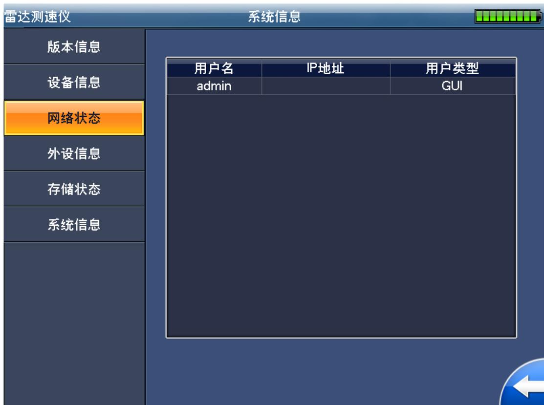
在此界面中显示所有当前登陆到测速仪系统的网络连接相关信息，包括用户名、对端 IP 地址和用户类型，其中用户类型包括：WEB 客户端、网络升级工具和平台软件。
