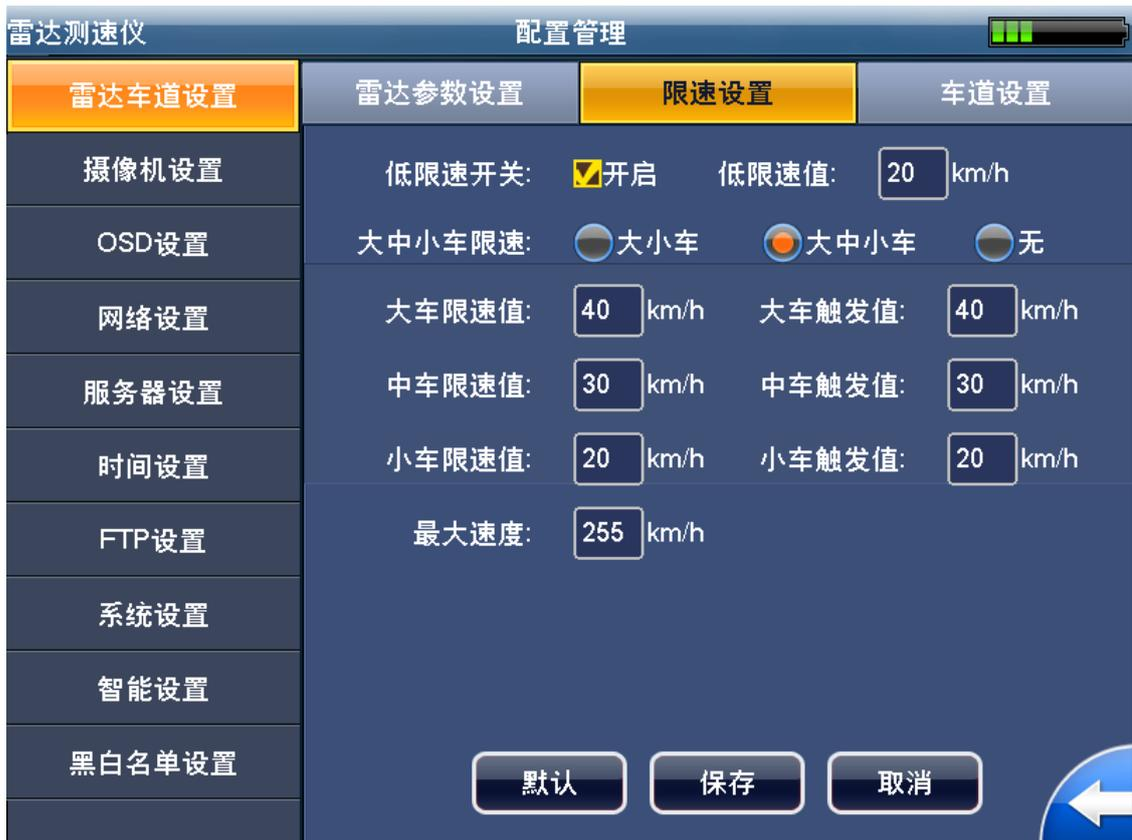
【低限速开关】设定是否开启低限速测量和抓拍功能；开启功能时，可设置低限速值。
