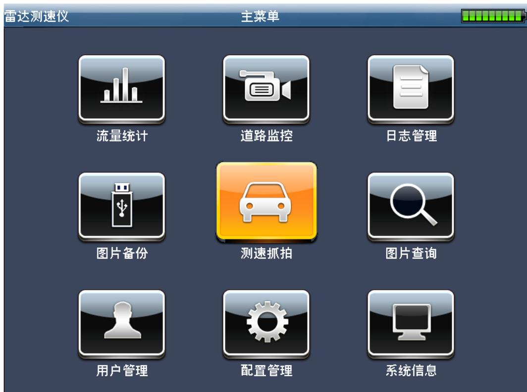
主菜单界面包括测速抓拍、道路监控、配置管理、图片查询、图片备份、系统信息、流量统计、日志管理、用户管理九个菜单。
