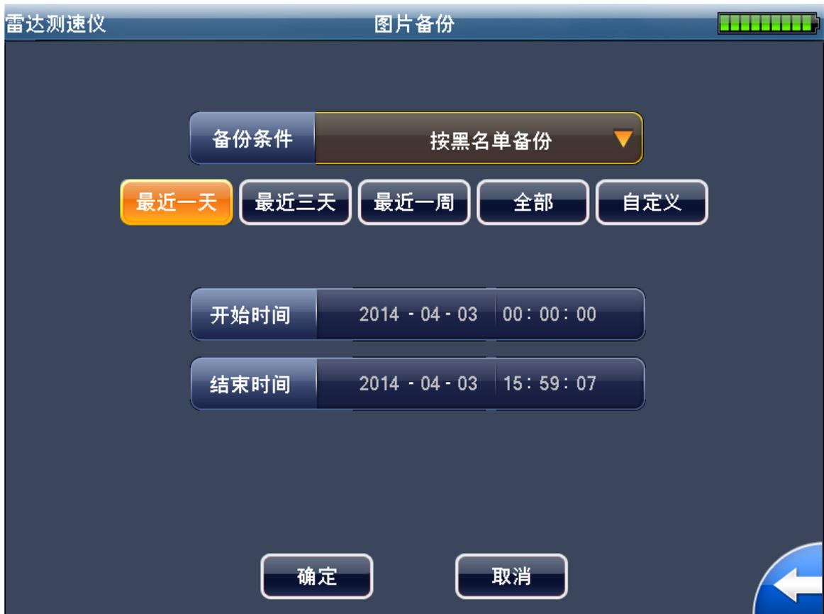
本地图片 USB 备份方式分为三种：按时间段备份、按速度段备份和按黑名单备份。按时间段备份精确到秒级；备份开始后，备份进度以进度条方式显示。备份完成后，弹出提示窗口提示用户完成备份。
