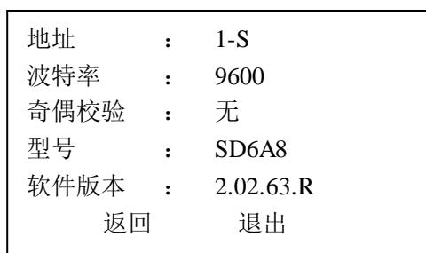
安装好球机并给其上电后，球机进行自检。球机自检正常，显示如上图所示的屏幕信息，在球机接收到第一个有效控制命令或显示时间超过 20s 后，此提示信息消失。
