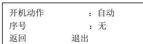
将光标移至“开机关动作”项并单击“确认”按钮进入此四级菜单层进行球机云台开机关动作的设置。
