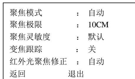
将光标移至“聚焦设置”项并单击“确定”按钮进入该三级菜单层进行聚焦的相关参数设置。
