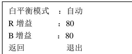
将光标移至“白平衡设置”项并单击“确定”按钮进入该三级菜单层进行白平衡的相关参数设置。
