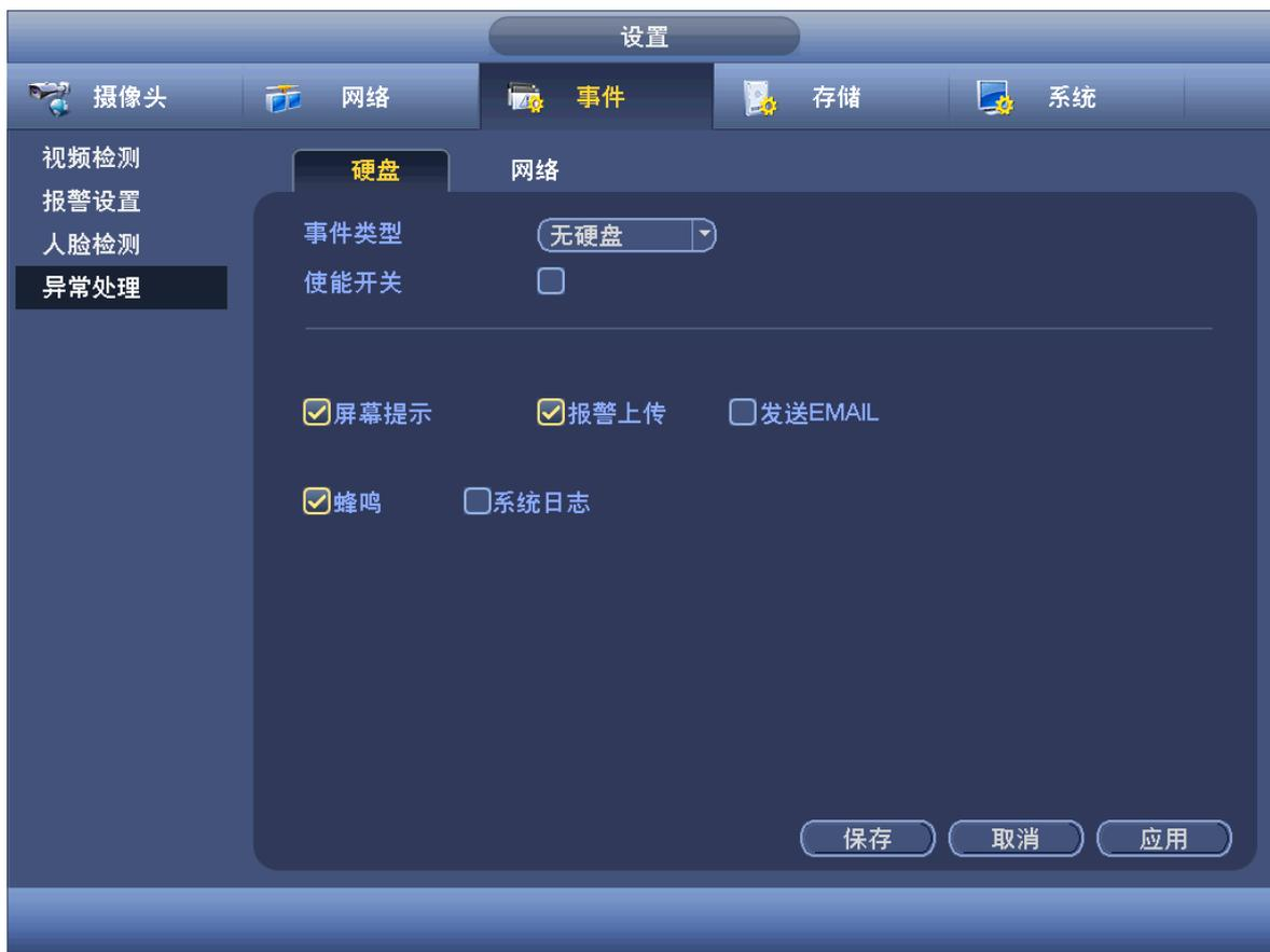
步骤2 选择事件类型，对各个异常事件设置各种处理方式。勾选相应时间类型的“使能开关”，设置才有效。
