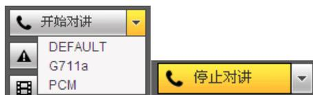
语音对讲功能实现设备端与客户端的双向通信。单击【开始对讲】按键，启动与设备端的语音对讲。单击【▼】下拉框箭头，进行选择语音对讲模式，有 DEFAULT、G711a 和 PCM 可选。单击【停止对讲】按键，结束本次语音对讲。
