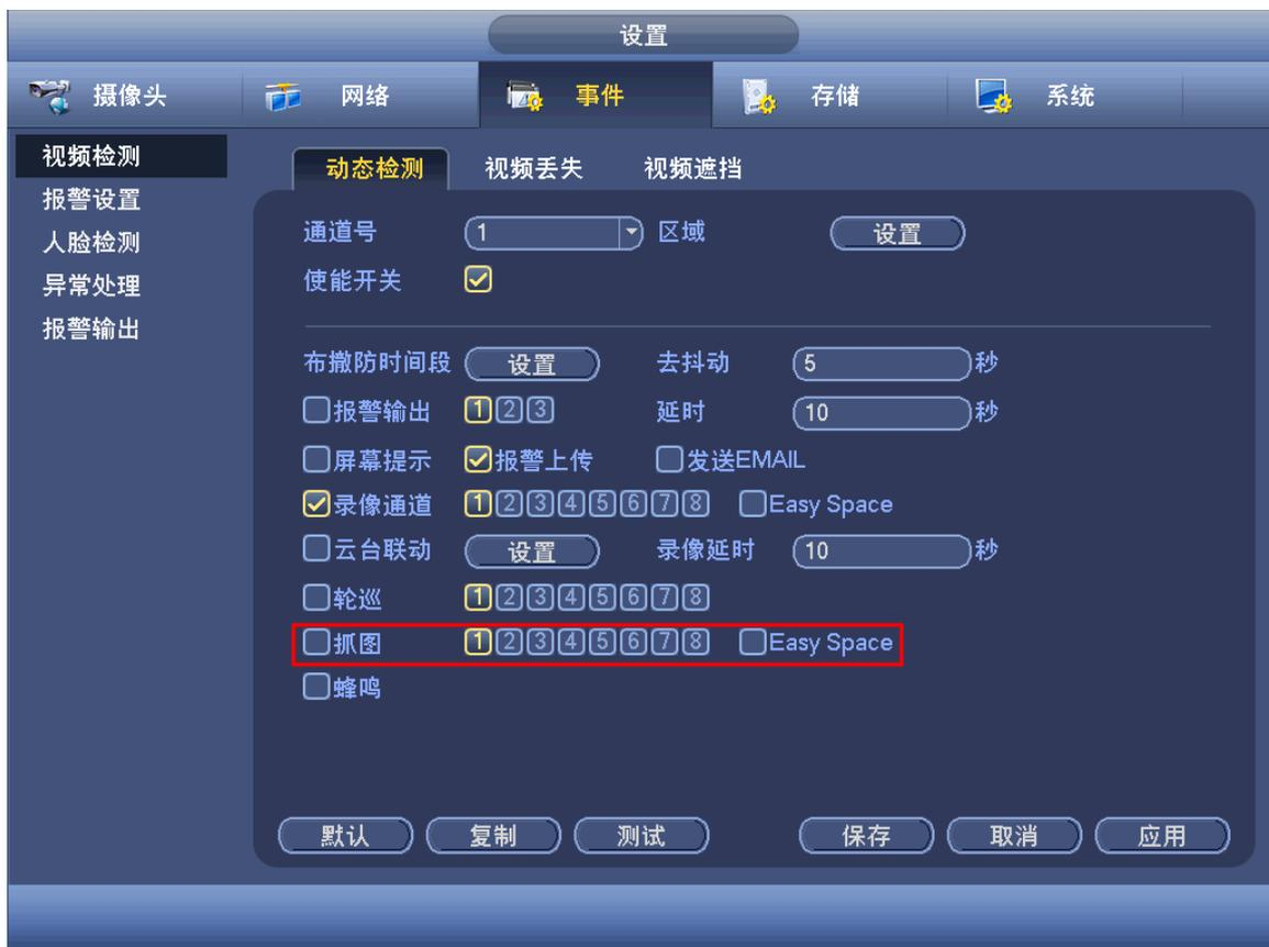
步骤4 上述操作后触发抓图功能被开启，若有相应的报警触发，本地就进行相应的抓图。
