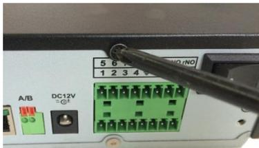
① 拆卸主机后面板及侧面板的固定螺丝，取下盖板
