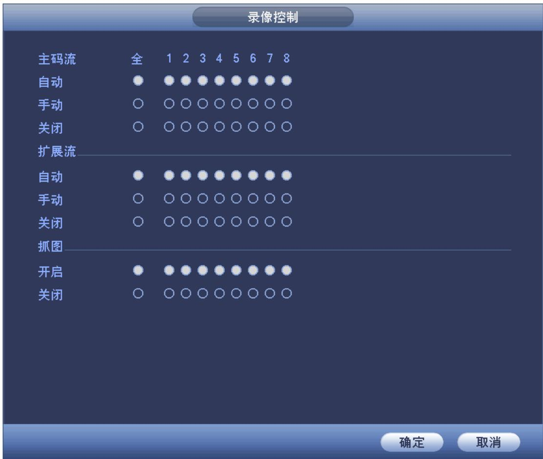
启动全部手动录像：将“手动”对应的“全”通道处于<sup>■</sup>状态即可（见下图红色标注）。启动全部手动录像后，不管用户在“录像设置”中设置何种录像类型，都将停止，全部通道都进行“普通录像”。此时前面板的录像指示灯全部变亮。
