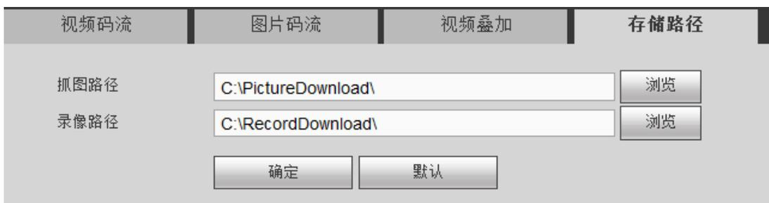
可分别设置手动抓图的存储路径和手动录像的存储路径。预览界面中手动抓图
