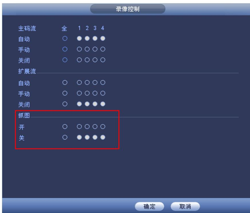
步骤2 选择“主菜单 > 设置 > 摄像头 > 编码设置 > 图片码流”，进入“图片码流”界面，如图 4-107 所示。
