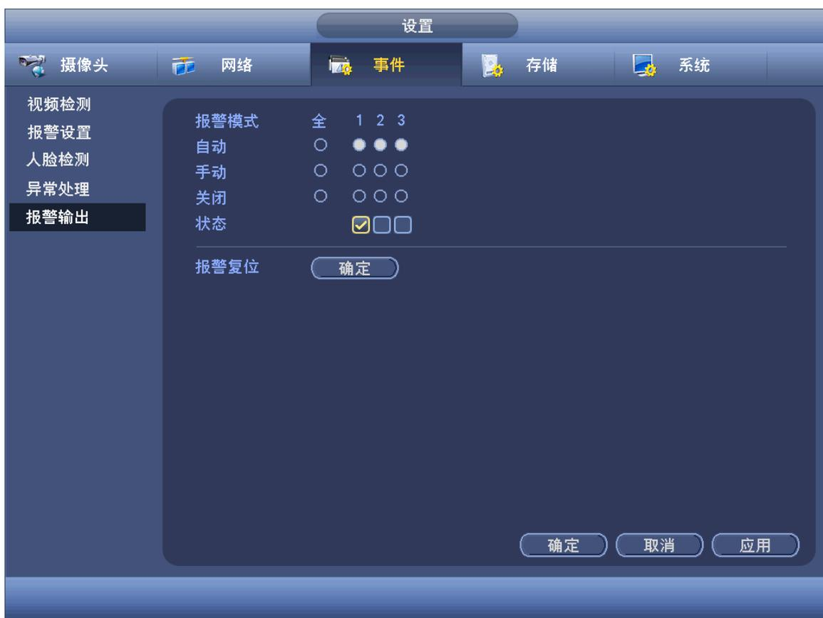
步骤2 选择报警输出各通道的报警模式。若单击“报警复位”的“确定”，则清除所有的报警输出状态。状态一栏可显示各报警出口的状态，若使能，则代表报警开启。
