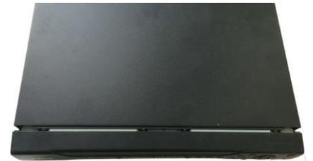
⑥ 对准中间卡扣，合上机箱盖，固定主机后背板及侧面板上的螺丝
