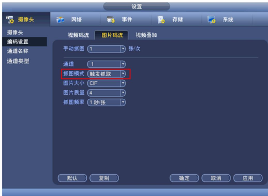
步骤3 在“主菜单 > 设置 > 事件 > 视频检测”或“主菜单 > 事件 > 报警设置”中，开启相应通道的“抓图”使能。
