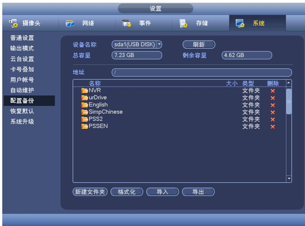
步骤2 插入外接设备，例如选择“配置”文件夹来保存配置，单击“导出”，则会在对应的路径下生成一个“Config\_时间”形式的文件夹。双击此文件夹，则看到所备份的一些配置文件。
