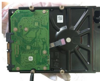
② 硬盘上固定四个螺丝（转三圈）
