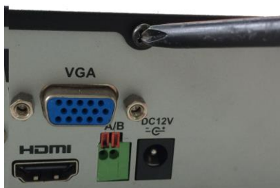
① 拆卸主机后面板及侧面板的固定螺丝，取下盖板。
