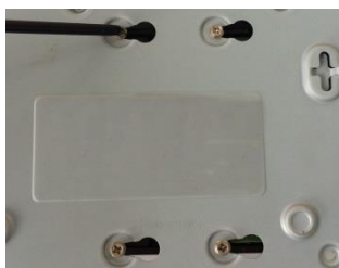
① 拆卸主机上盖的固定螺丝，取下上盖。
