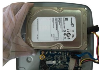
③ 把硬盘对准底板的四个孔放置
