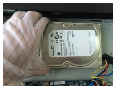
③ 把硬盘对准底板的四个孔放置
