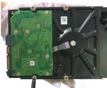
② 硬盘上固定四个螺丝（转三圈）
