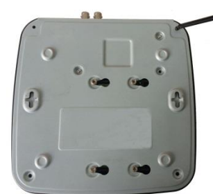
⑥ 合上机箱盖，固定主机后背板螺丝
