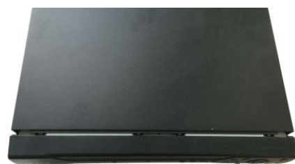
⑥ 对准中间卡扣，合上机箱盖，固定主
