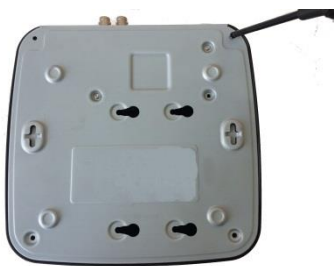
① 拆卸主机上盖的固定螺丝，取下上盖。
