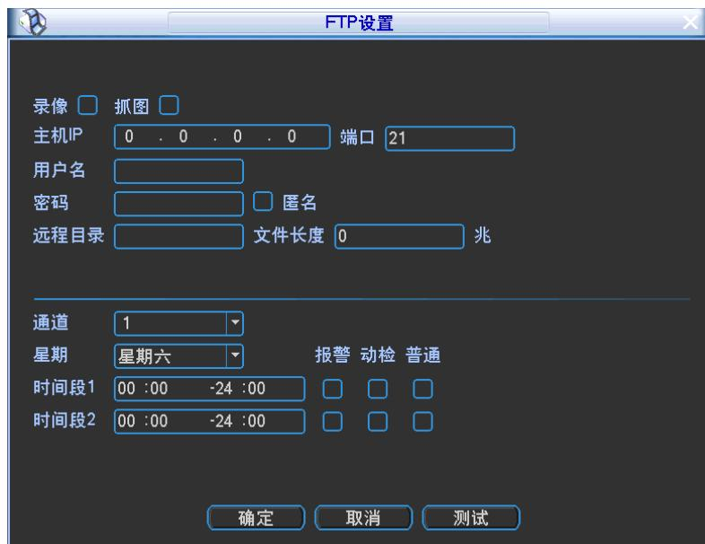
2. 设置 FTP 服务器地址、端口、远程目录等。远程目录为空时，系统会自动按 IP、时间、通道建立不同的文件夹。
