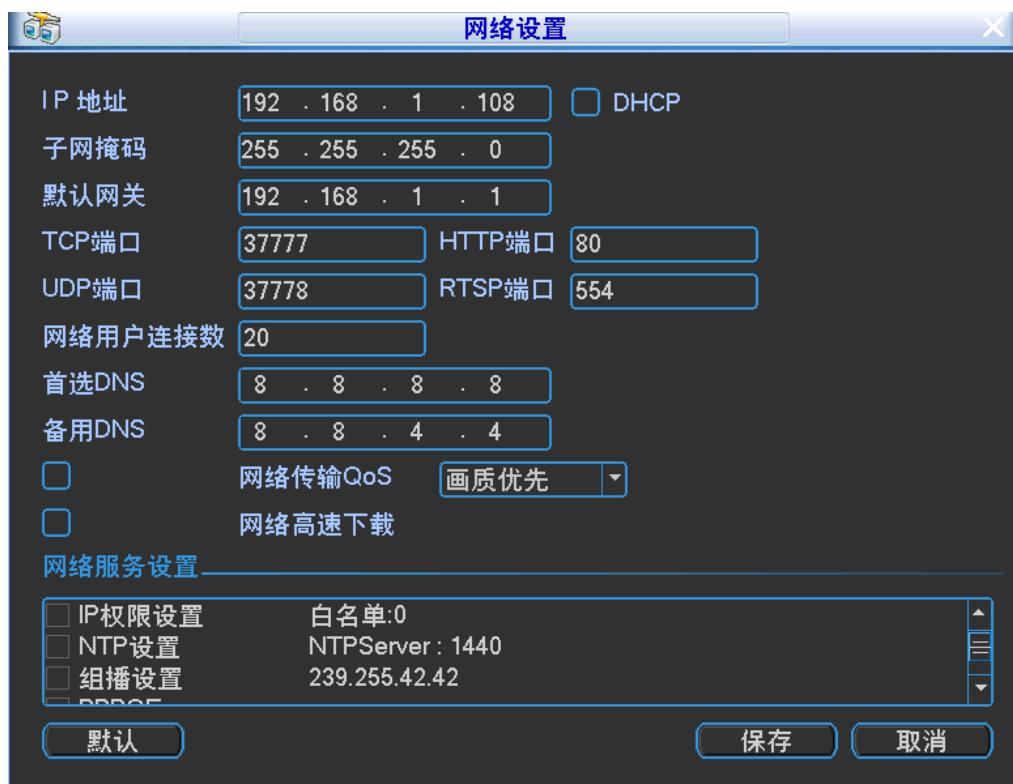
【TCP 端口】一般默认为 37777，可根据用户实际需要设置端口。
