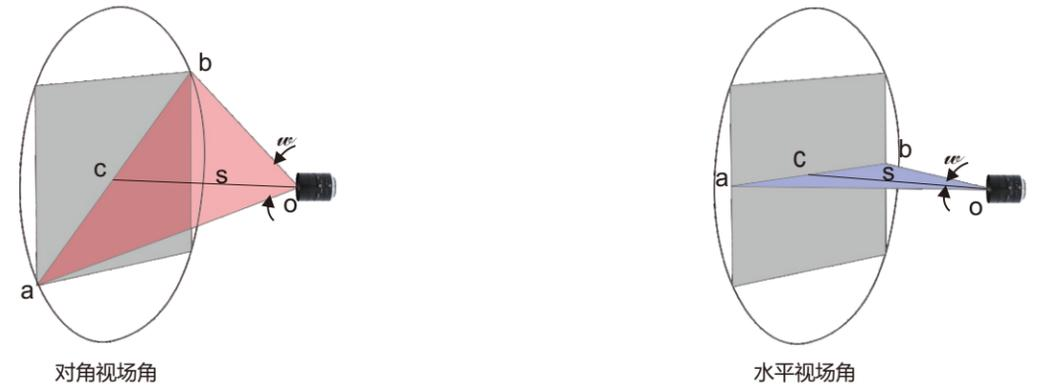
相同像面下，镜头焦距与视场角成反比，即焦距越大，视场角越小，反之视场角越大。相同焦距下，视场角大小也会随着摄像机像面尺寸的变化而变化
