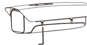
▶2 用十字螺丝刀取下“摄像机支架”，然后将摄像机固定在支架上。将摄像机固定在支架上有两种不同的方式：
