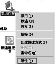
步骤2 查看并修改PC的IP地址，使之与别墅门口机的IP地址在同一网段，以实现PC和别墅门口机之间网络互通。
