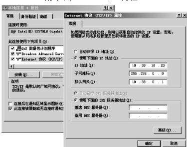
步骤3 完成修改后，选择“开始>运行”，输入cmd，单击“确定”进入命令界面。输入“ping+别墅门口机IP”。如果有通讯数据，则说明书网络互通。
