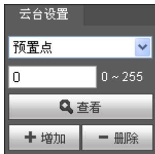
图3-5 预置点设置示意图
