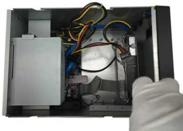
④ 把减震圈安装到硬盘托架上
