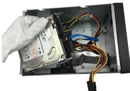
⑥ 安装硬盘的电源线和 SATA 接口线
