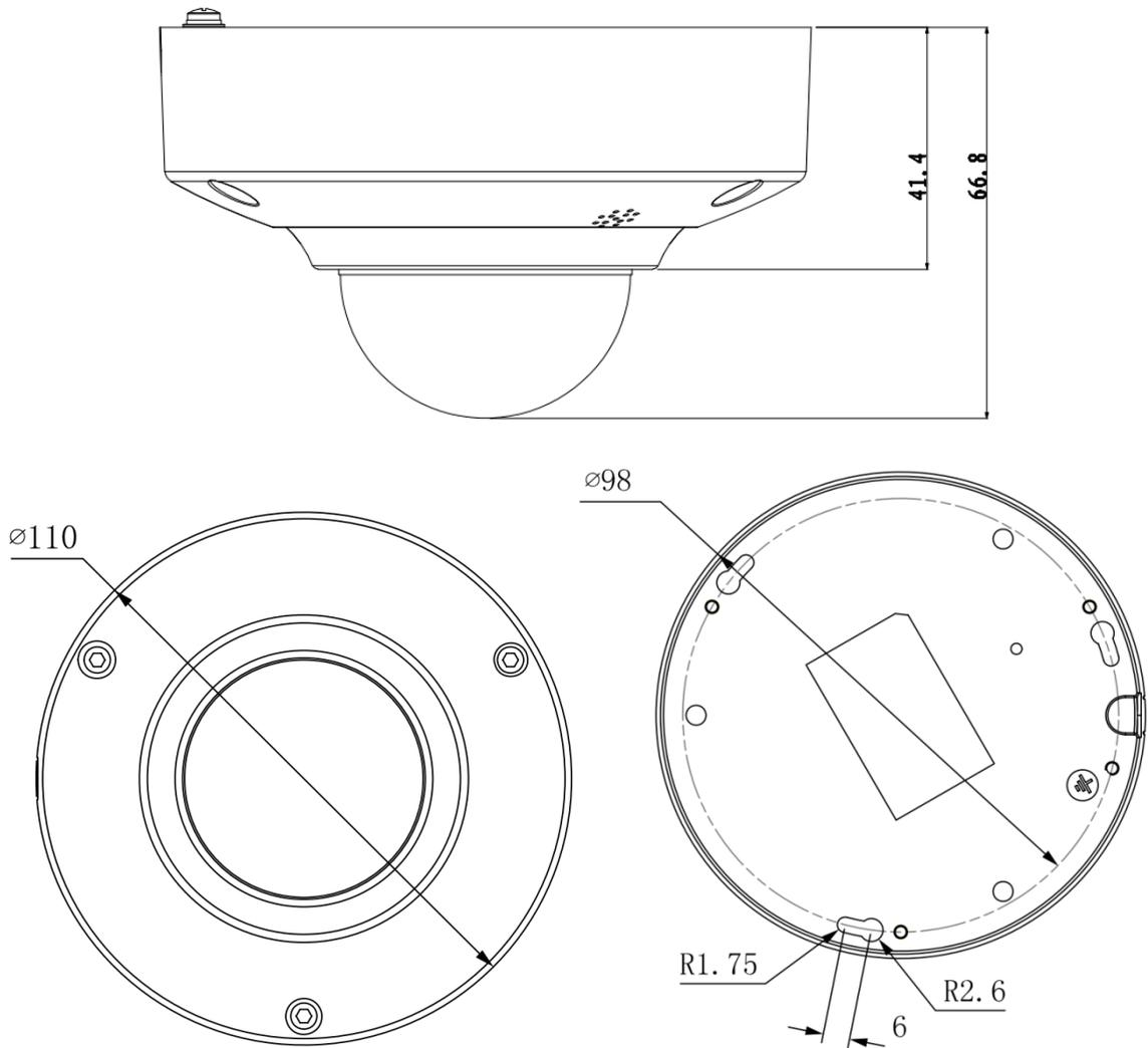
图2-3 结构尺寸示意图（2）（单位：mm）
