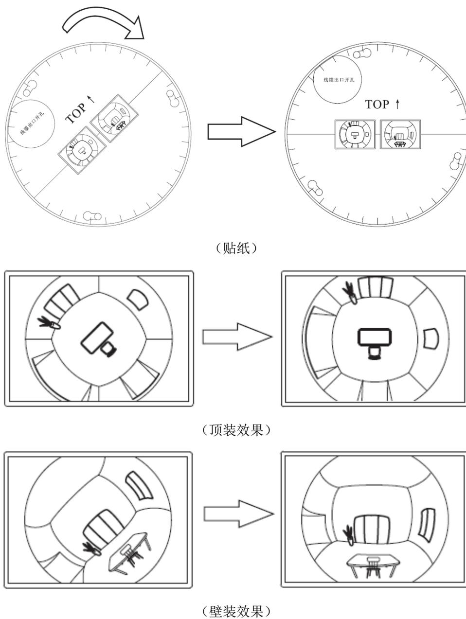
图3-2 设备安装示意图
