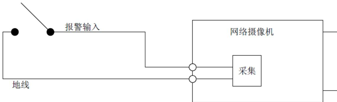
报警输入：输入信号悬空或者接地，设备可以采集到报警输入口的不同状态。其中输入信号接 3.3V 或者悬空，设备采集到逻辑“1”；输入信号接地，设备采集到逻辑“0”。
