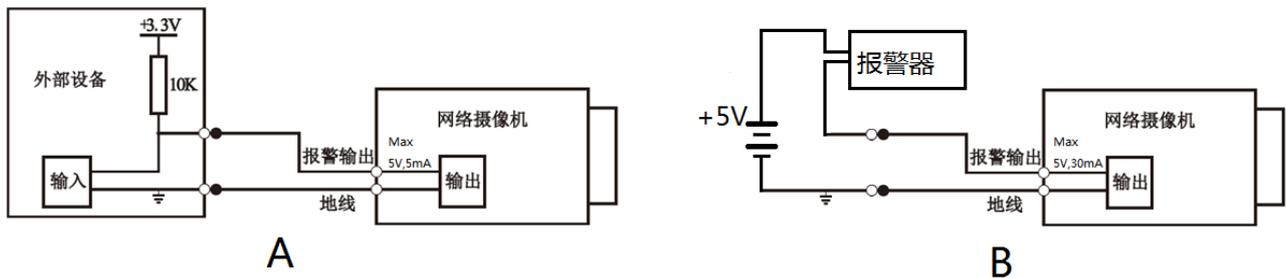
方式 A：电平应用。报警输出高低电平，报警输出为 OC 门，需要外部增加上拉电阻才能正常工作。外部上拉电平最大为 5V，端口电流最大为 5mA，增加外部上拉电阻，输出信号默认为高电平（外部上拉电压），当有报警输出的时候，输出信号变为低电平（工作电流 5mA 时，输出电压小于 0.8V）。
