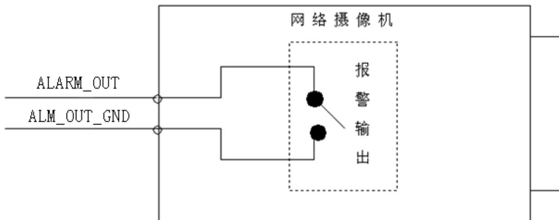
报警输出：端口 ALARM\_OUT 和 ALM\_OUT\_GND 组成一个开关，用于提供报警输出。平时此开关打开，当有报警输出时，此开关关闭。
