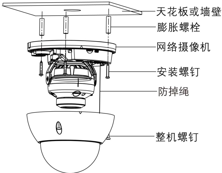
步骤1 用附件包中的花形扳手拧开半球防护外罩上的三颗花形头型螺丝，打开半球护罩。
