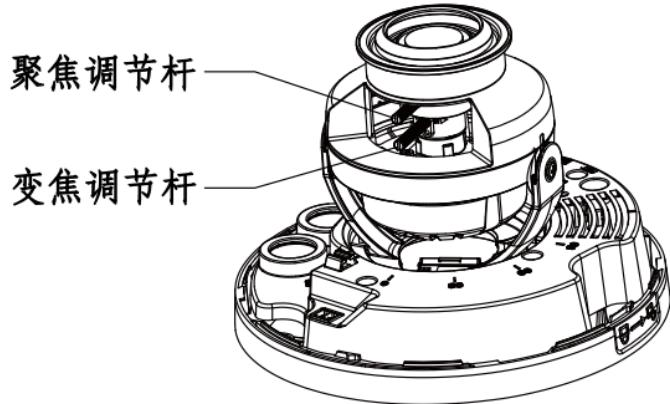
1. 微微旋松变焦调节杆，再轻轻拨动变焦调节杆使其摆动，根据图像显示将镜头聚焦清晰，再将变焦调节杆锁紧。
