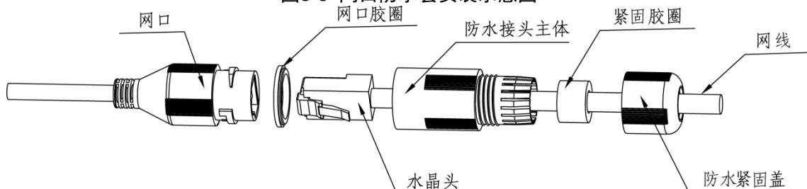
1. 将网口胶圈按凸槽朝外的方式装到网口上，并将紧固胶圈按胶圈小孔朝外的方式装入防水接头主体中。
