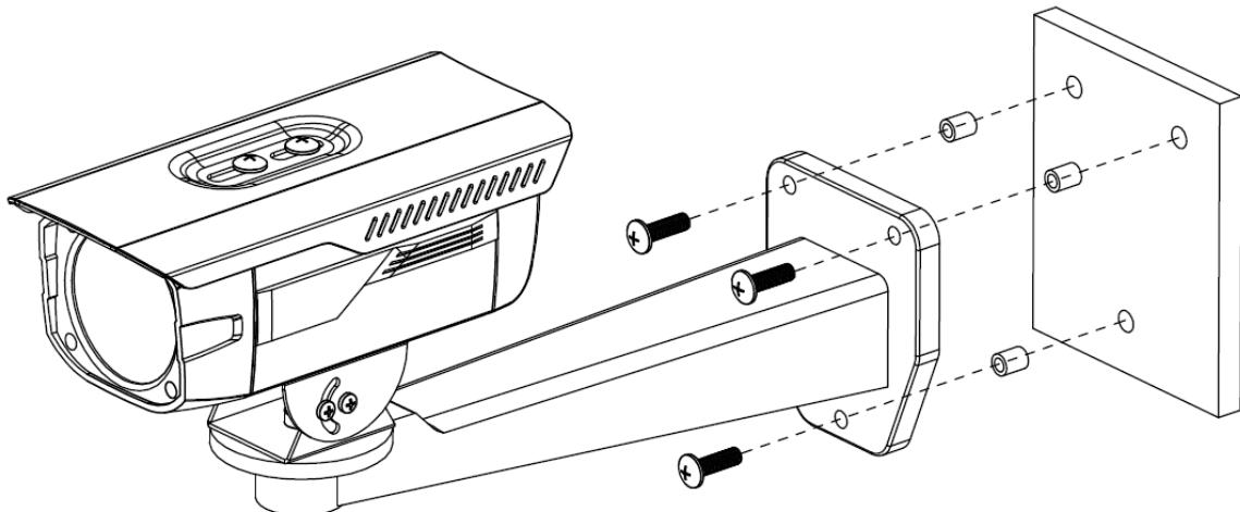
1. 在安装面上标示支架安装孔位，并在安装面标示孔位上打四个膨胀螺栓底孔，然后将四颗膨胀螺栓敲入到安装孔中并锁紧。
