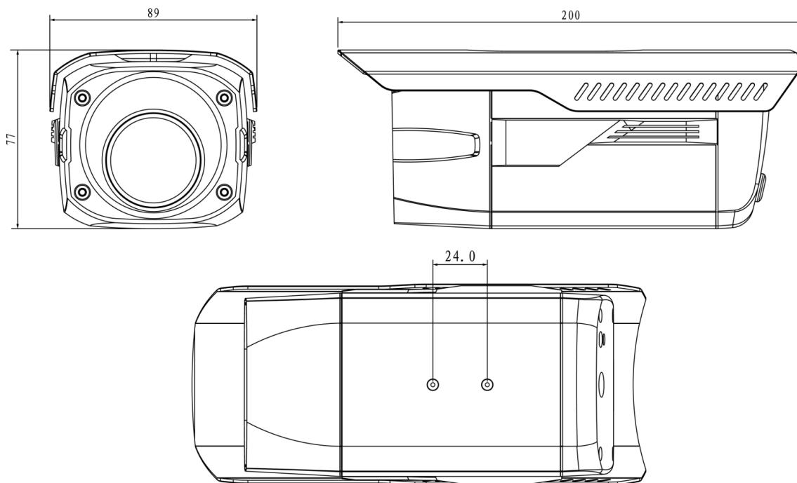
图2-3 结构尺寸示意图（2）（单位：mm）
