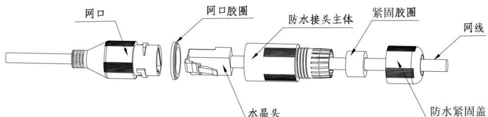
1. 将网口胶圈按凸槽朝外的方式装到网口上，并将紧固胶圈按胶圈小孔朝外的方式装入防水接头主体中。
