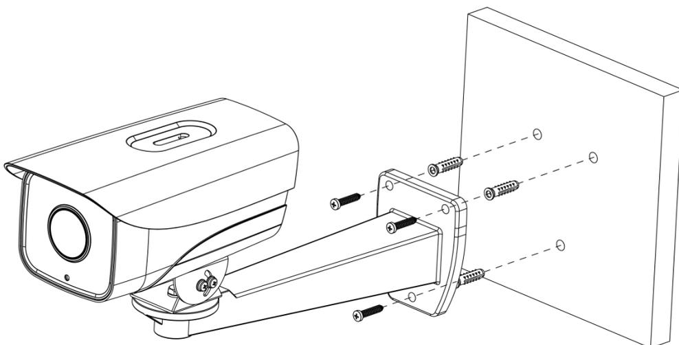
1. 在安装面上标示支架安装孔位，并在安装面标示孔位上打四个膨胀螺栓底孔，然后将四颗膨胀螺栓敲入到安装孔中并锁紧。
