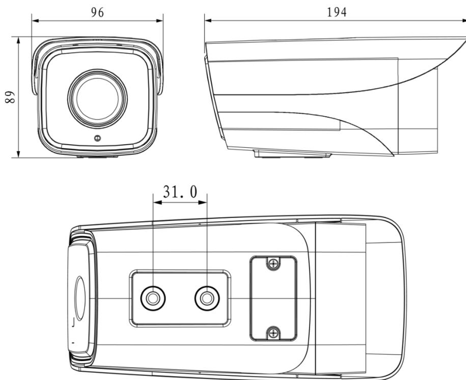
图2-3 结构尺寸示意图 (2) (单位: mm)
