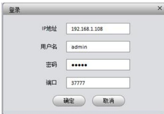
步骤3 输入摄像机的 IP 地址、用户名、密码和端口号，单击“确定”。
