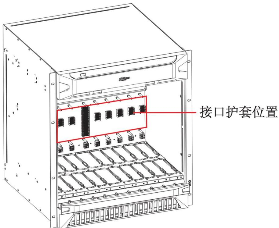
步骤4 将主控板的接口板及前面板插入机箱的“M”标号的槽位中并拧紧螺丝。
