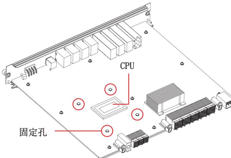
步骤2 将主控板背面的风扇固定圈对准固定孔的位置放好，然后将风扇固定在 CPU 上面。
