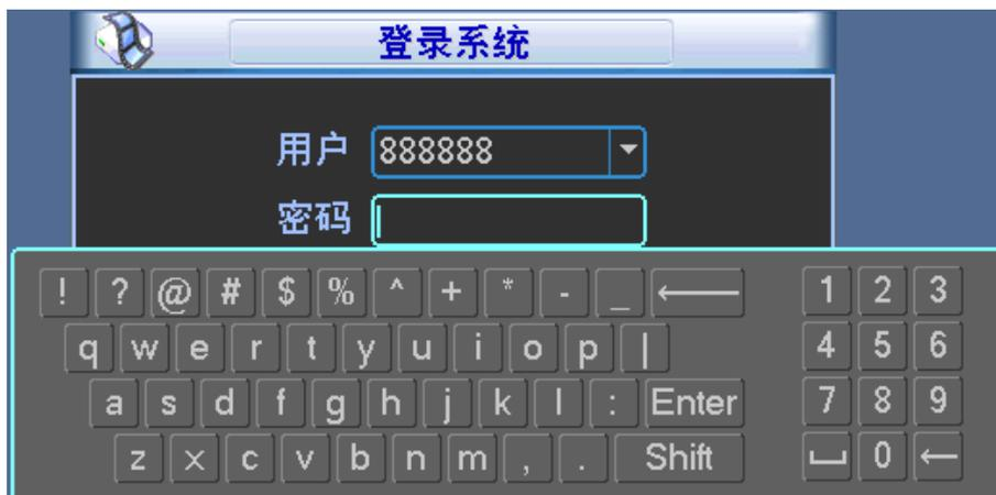
步骤3 用户在输入框中输入用户名和密码，输入完成后，单击“确定”。
