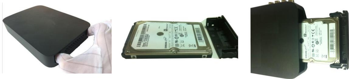
① 拔出设备中的硬盘托架。
