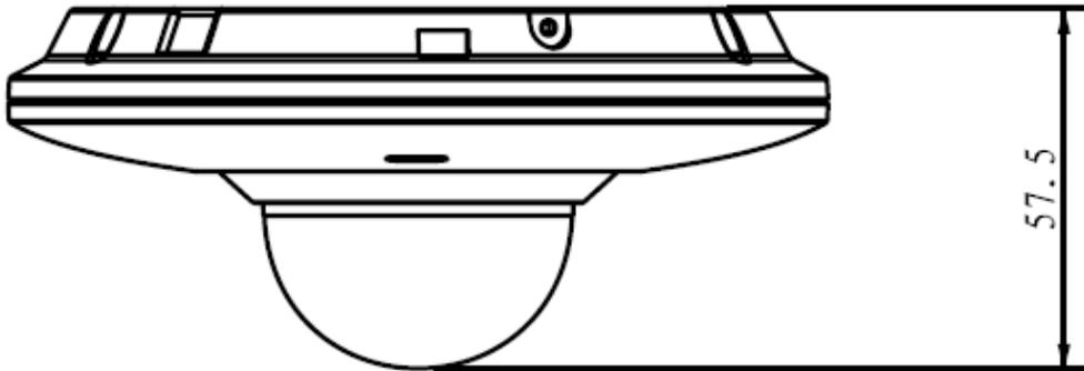
图2-4 结构尺寸示意图（1-b）（单位：mm）
