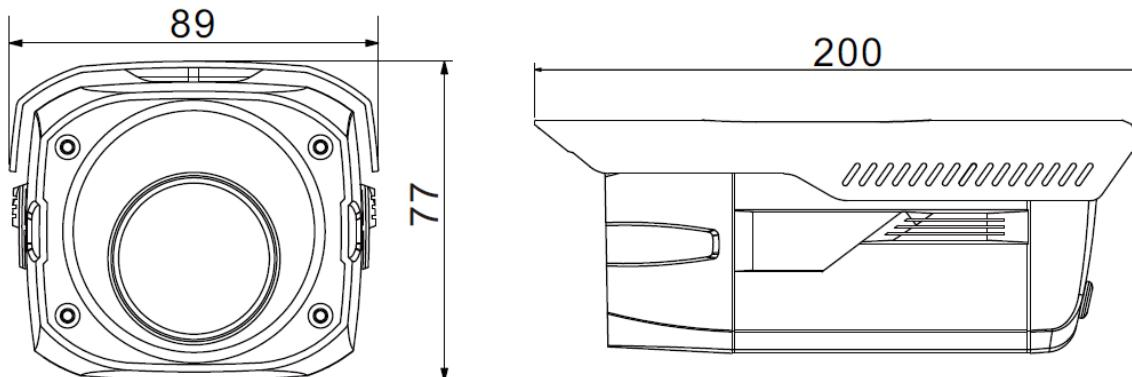
图2-3 结构尺寸示意图（2）（单位：mm）
