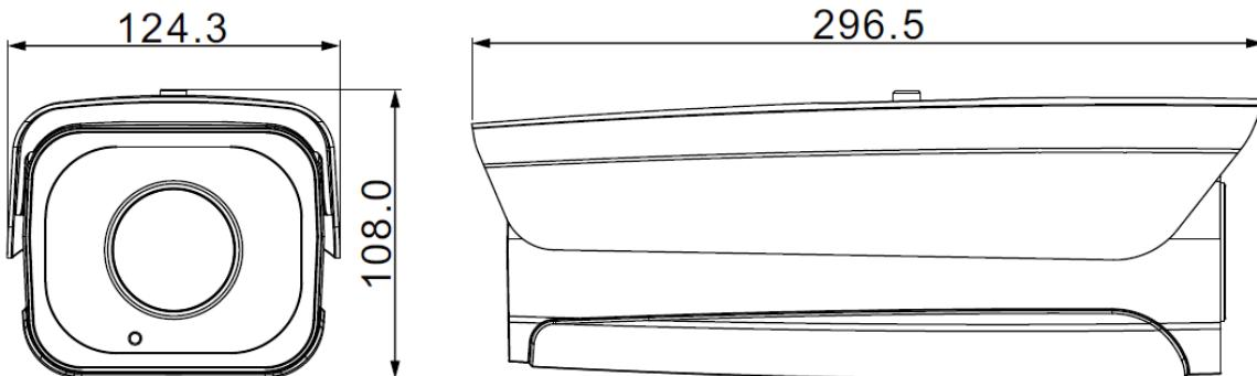
图2-5 结构尺寸示意图（4）（单位：mm）
