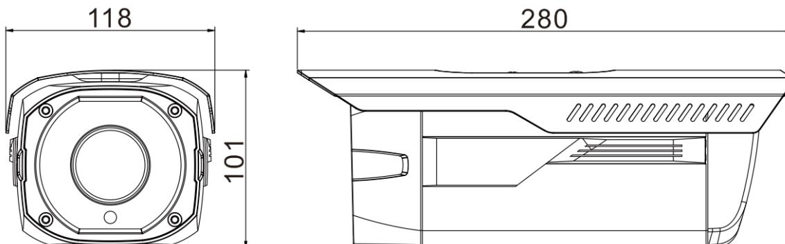
图2-4 结构尺寸示意图（3）（单位：mm）
