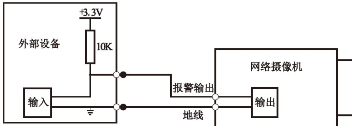
报警输出：报警输出为OC门，需要外部增加上拉电阻才能正常工作，输出信号为高低电平。增加外部上拉电阻后，输出信号默认为高电平，当有报警输出的时候，输出信号变为低电平。
