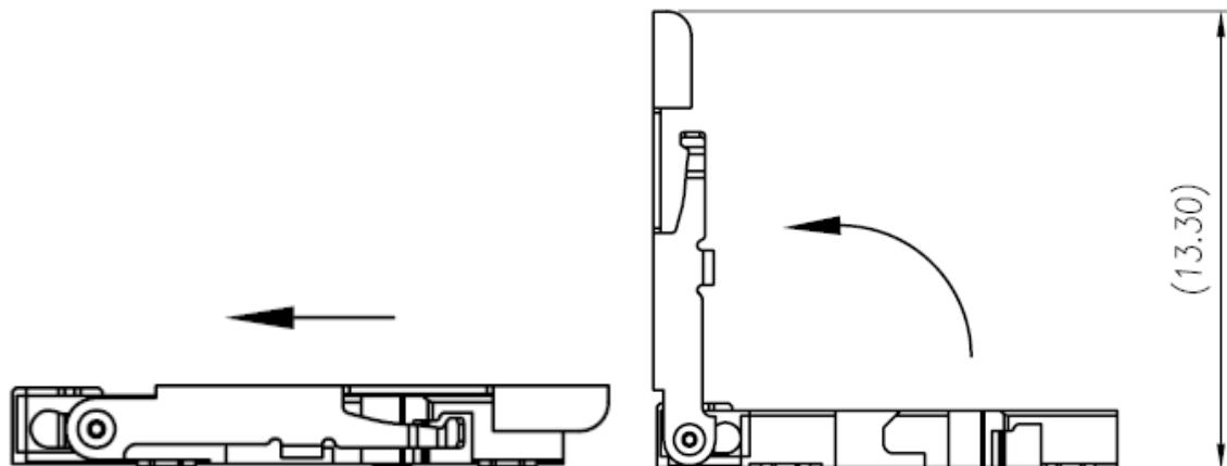
图3-5 Micro SD 卡安装示意图 (2)
