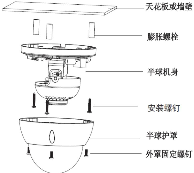
图3-2 安装示意图 (1-b)
