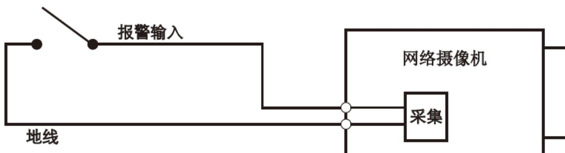
报警输入：输入信号悬空或者接地，设备可以采集到报警输入口的不同状态。其中输入信号接 3.3V 或者悬空，设备采集到逻辑“1”；输入信号接地，设备采集到逻辑“0”。
