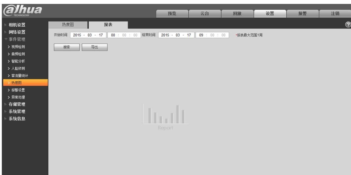
统计监视画面的热度，可生成报表，颜色跨度从蓝到红，蓝色表示热度值最低，红色表示热度值最高。
