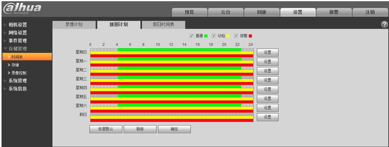
步骤4 在“抓图计划”界面上单击“确定”，系统提示“保存成功”，抓图计划时间表设置完成。
