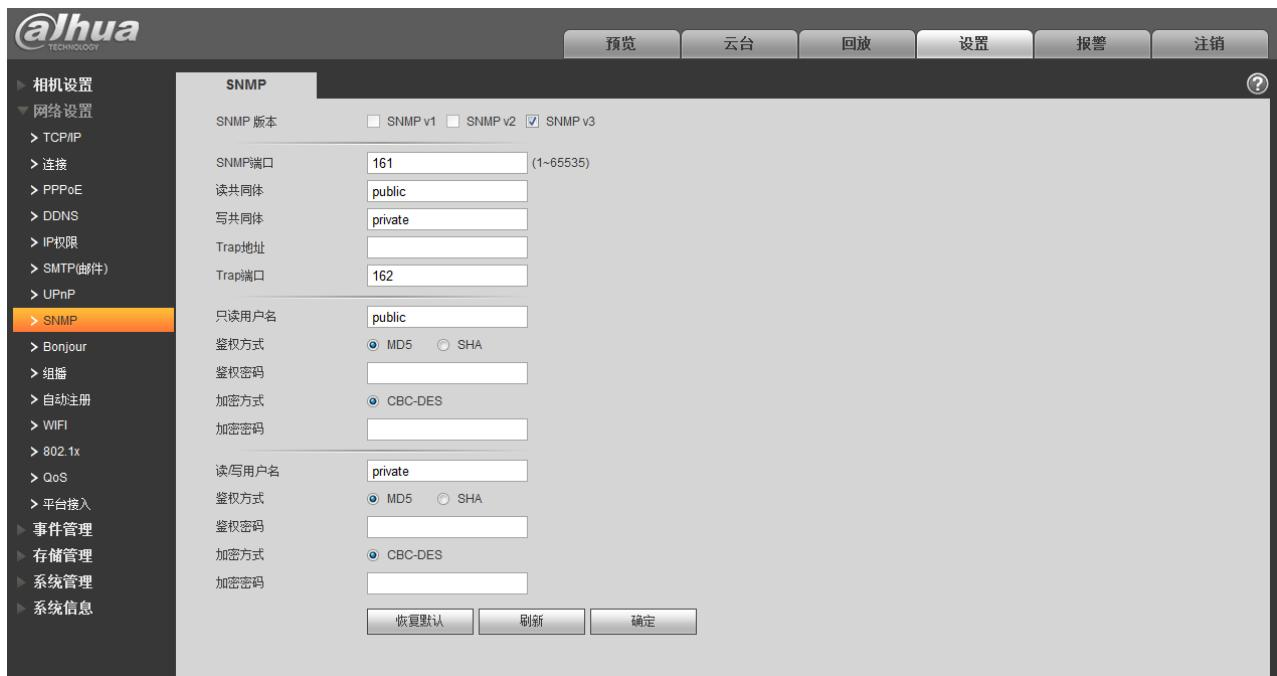
勾选 SNMP v3 版本时，如图 5-32 所示，其中 SNMP 端口、读共同体、写共同体、Trap 地址、Trap 端口等参数的设置与 SNMP v1、SNMP v2 版本相同。只有当“SNMP 版本”为“SNMP v3”时需要配置下表中的参数。
