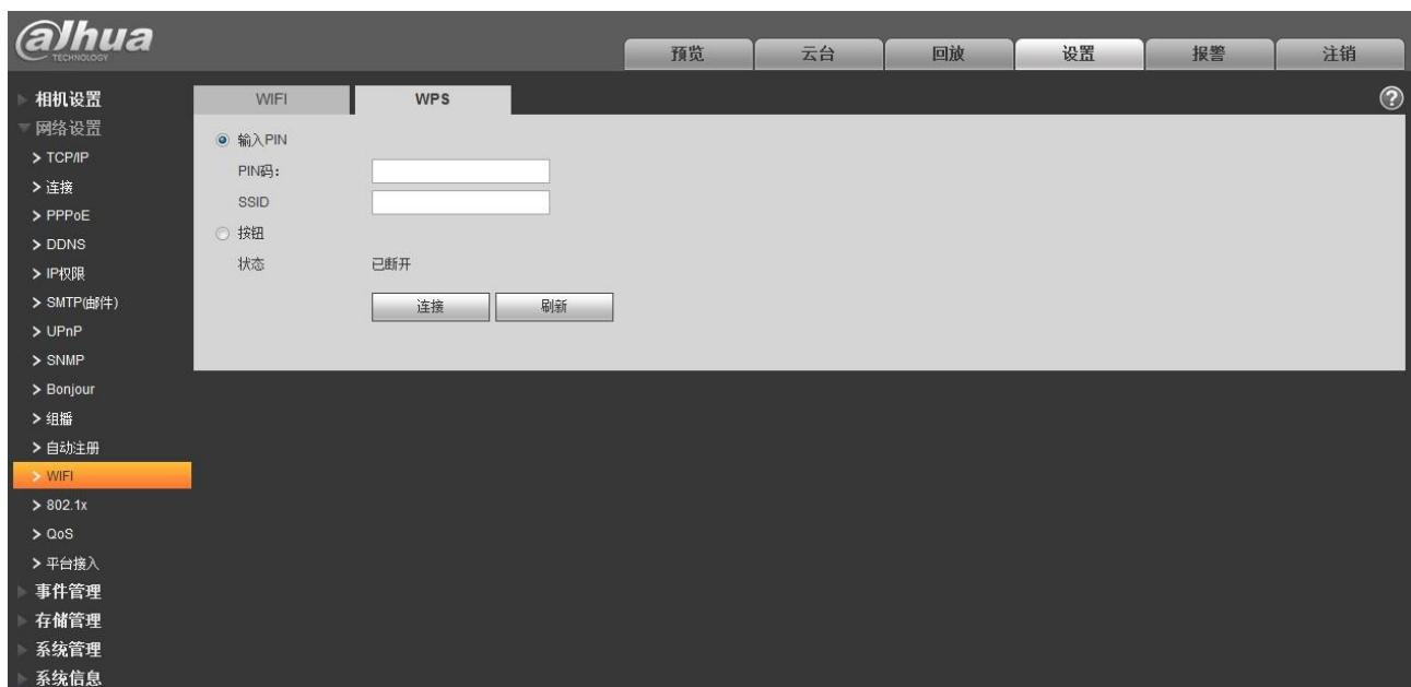
PIN 码和 SSID 项均由路由器获取，填写正确后请“刷新”WIFI 的工作信息才能保证工作状态的实时显示。
