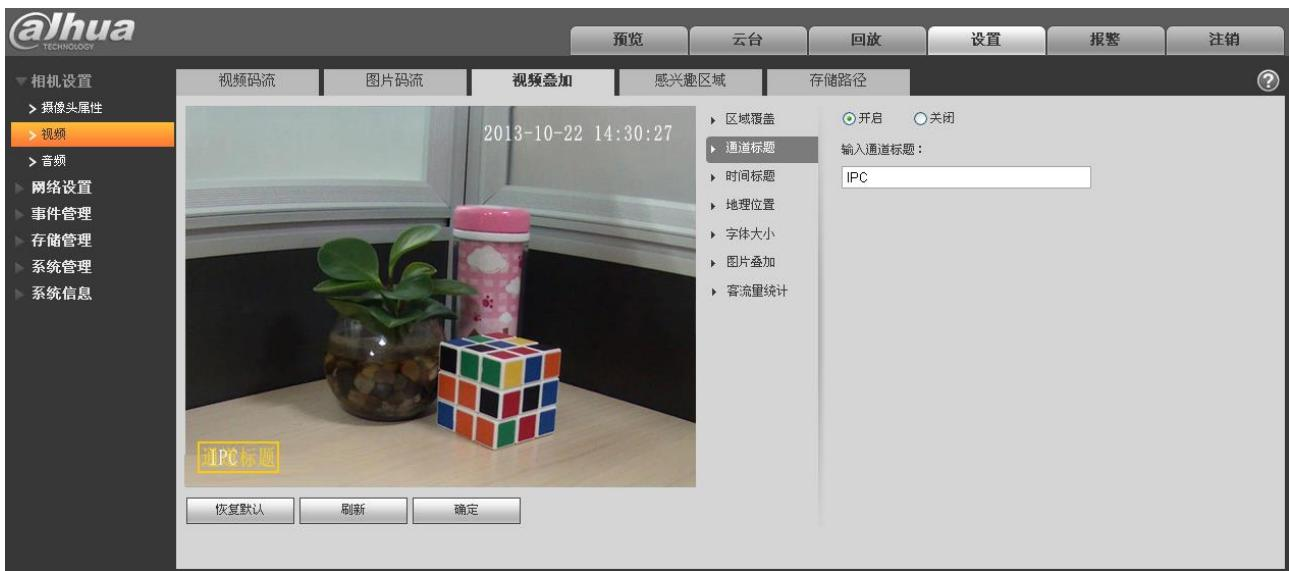
图5-11 视频叠加-时间标题设置示意图
