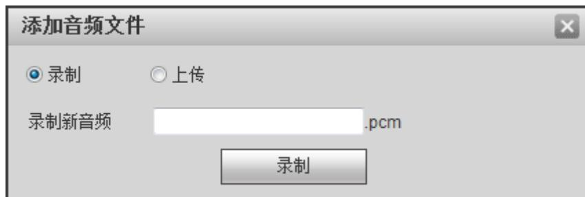
音频管理目前支持 pcm 一种格式录制和 pcm、wav2 种格式上传，且可选中某个音频文件为报警联动音频。
