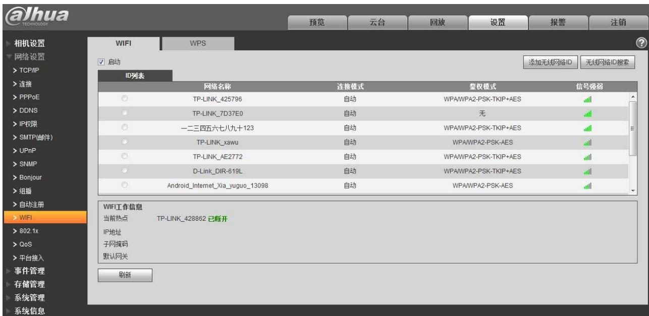
步骤3 需要手动添加无线网络时，点击“添加无线网络 ID”，弹出如下图所示界面，在对话框中输入网络 ID。
