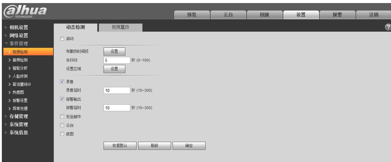
图5-46 视频检测-视频篡改设置示意图
