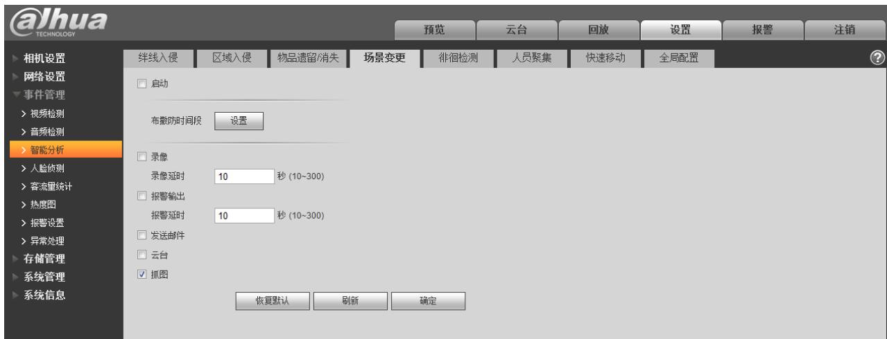
图5-54 智能分析-徘徊检测设置示意图
