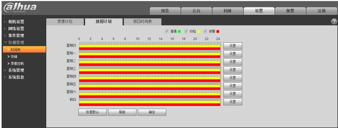
步骤2 在“星期一～星期日”中选择需要抓图的时间，单击右侧的“设置”，显示如图 5-76 所示界面。
