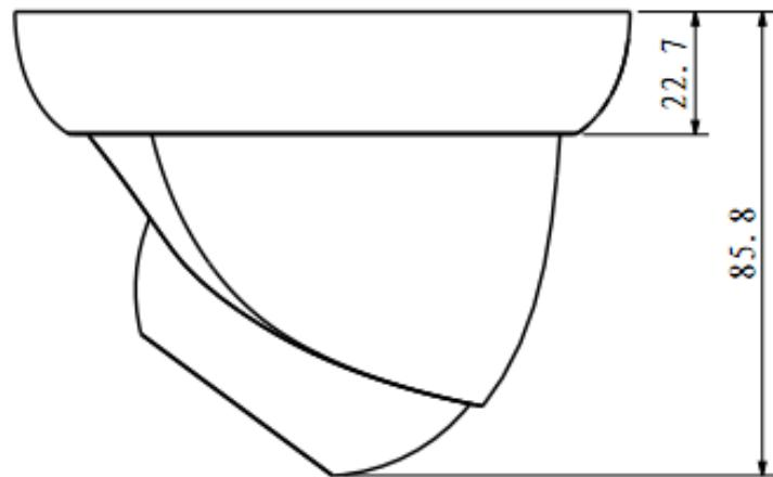
图2-5 塑料海螺结构尺寸示意图（2）（单位：mm）
