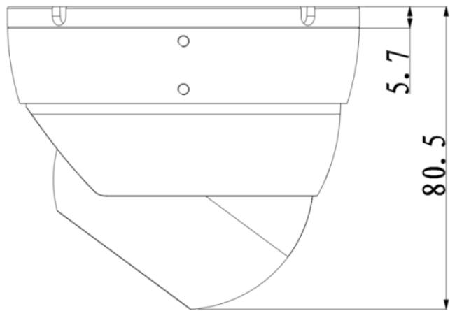
图2-3 金属海螺结构尺寸示意图（2）（单位：mm）
