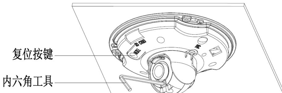
步骤6 拿起半球防护外罩，对准线缆出口位置，盖上外罩。然后将 3 颗内六角固定螺丝用内六角扳手拧紧，完成安装。
