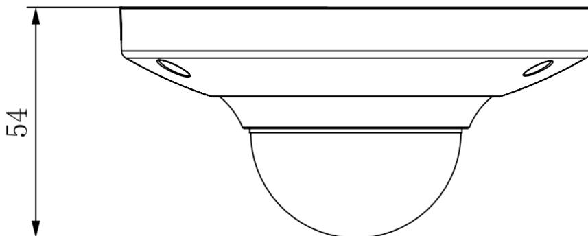
图2-3 结构尺寸示意图（2）（单位：mm）
