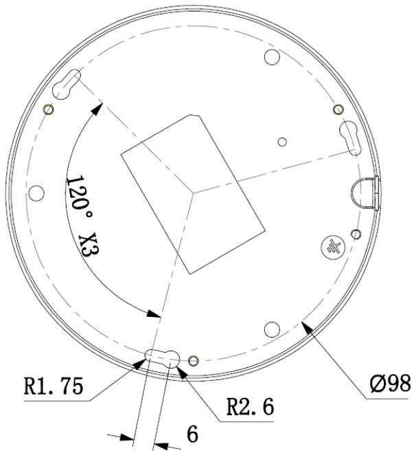
图2-4 结构尺寸示意图（3）（单位：mm）
