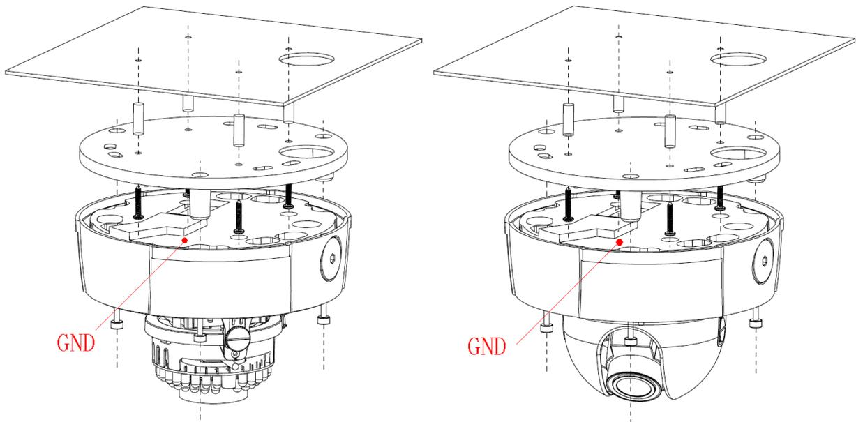
步骤 3 在天花板及其他安装面上，标示四个塑料膨胀螺栓底孔与线缆出线孔位置，接着在安装面上打出塑料膨胀螺栓底孔与线缆出线孔，然后将四颗塑料膨胀螺栓敲入到膨胀螺栓底孔中。
