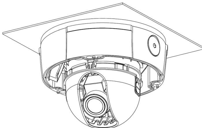
步骤 6 调整三轴转动模块，将设备镜头调整到所需位置。
