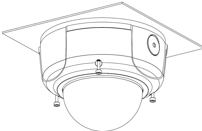
步骤 7 盖上半球防护外罩，然后将三颗内六角固定螺丝对准到设备主机的螺丝孔中，并用内六角扳手拧紧。
