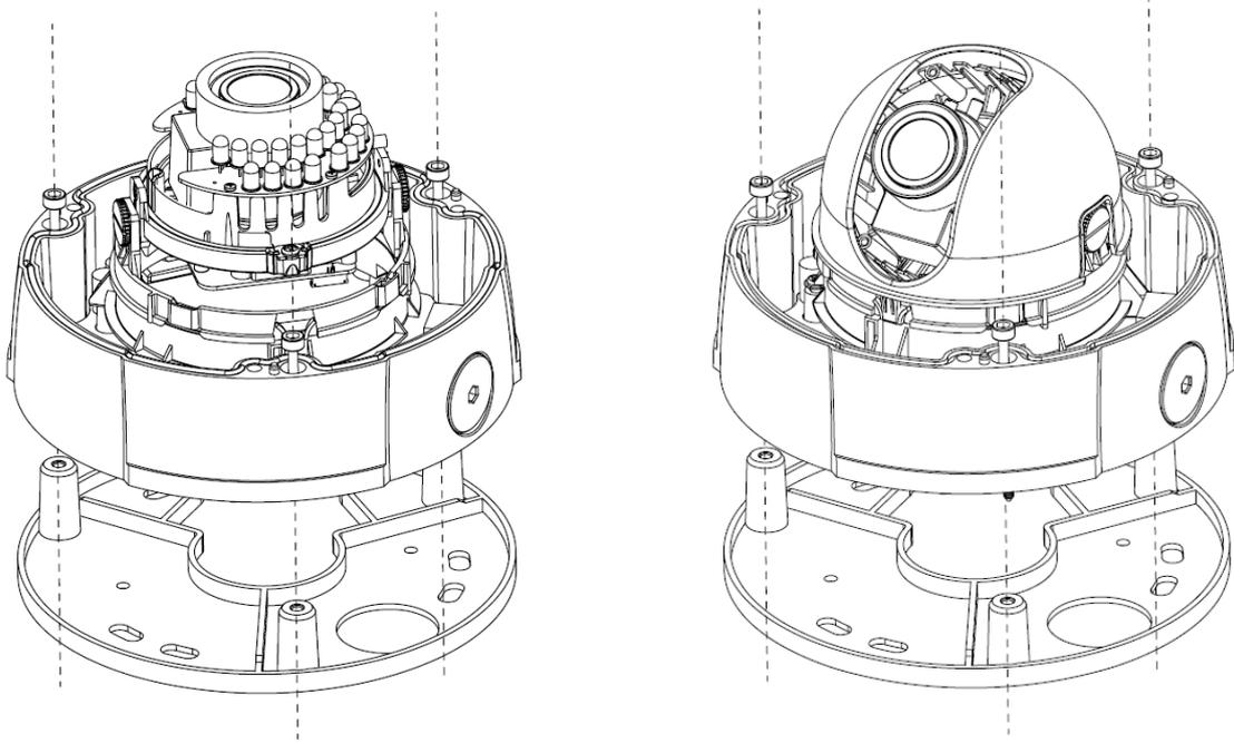
步骤 2 用附件包中的内六角扳手拧松半球主机上的三颗内六角螺丝，卸下安装设备安装底座。
