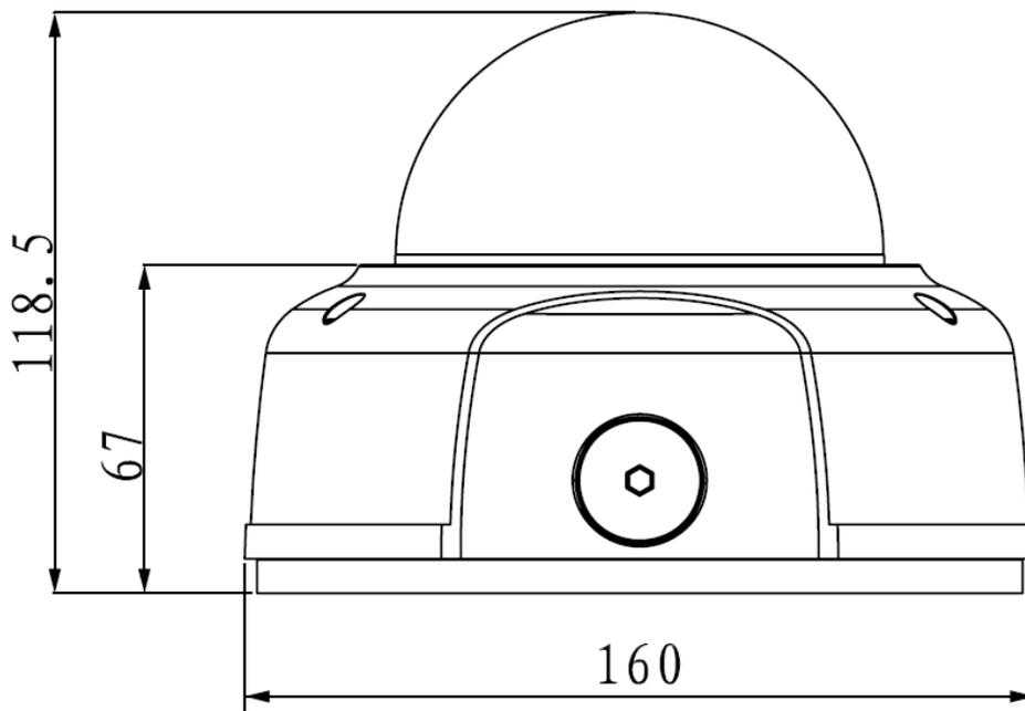
图2-3 结构尺寸示意图（2）（单位：mm）
