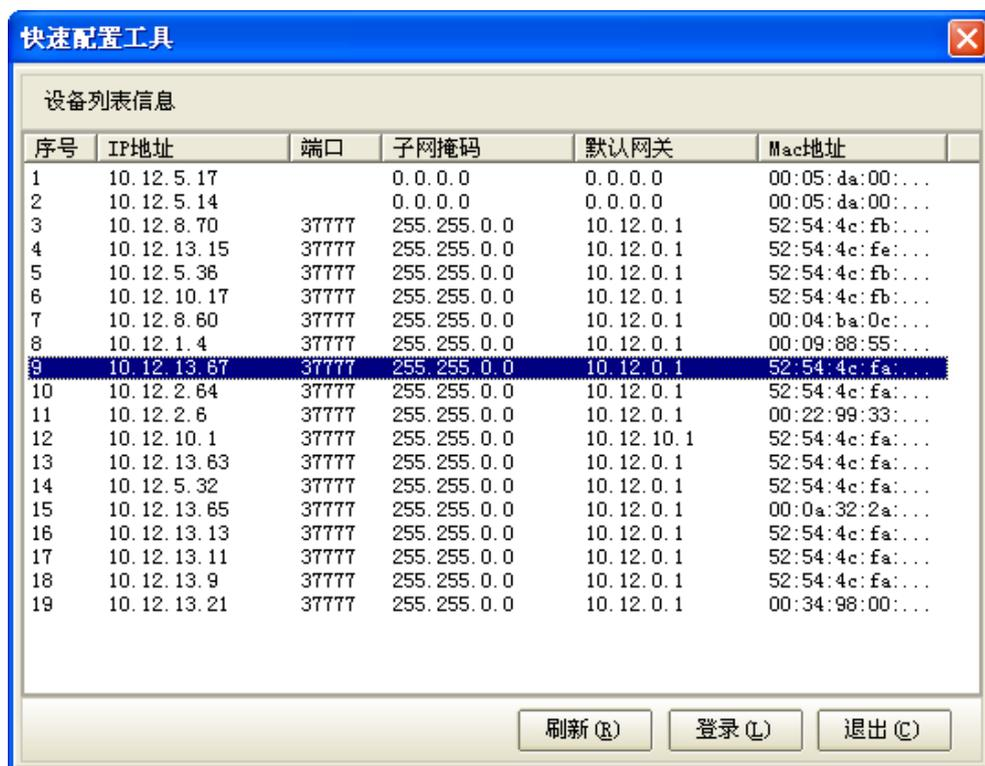
步骤2 选中搜索到的设备 IP 地址后，右键单击该 IP 地址显示“打开设备 Web 页”选项。单击该命令后即可打开对应 IP 地址的设备 WEB 登录页面。
