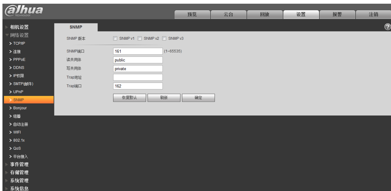
图5-30 网络设置-SNMP 设置示意图（1）
