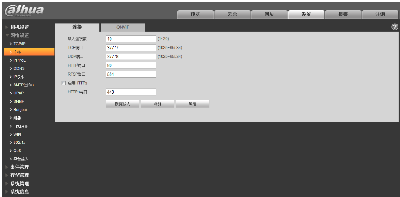
图5-22 网络设置-连接设置示意图
