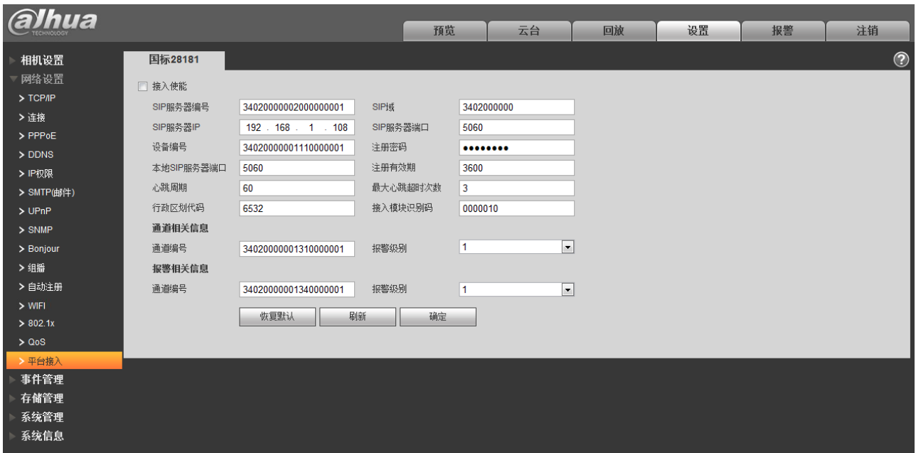
图5-43 网络设置-平台接入-国标 28181 设置示意图
